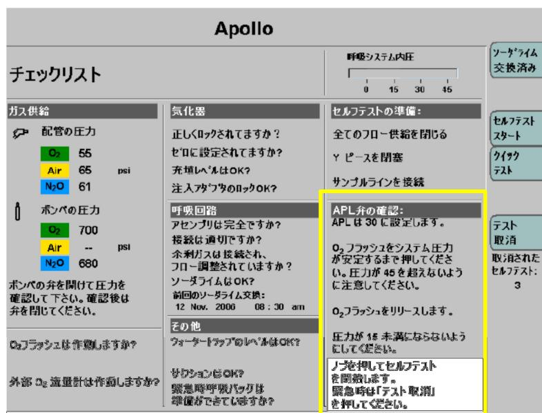
自動テストでは、機械換気時の正常な動作を保証するために、APL バイパスバルブに 20mbar の陰圧をかけてテストを行います。手動テストでは、APL バルブを 30cmH<sub>2</sub>O に設定して O<sub>2</sub> フラッシュにより陽圧をかけます。圧力が 15mbar に低下しなければテストは合格となります。この手動テストで、APL バイパスバルブと APL バルブの正常な動作がチェックされます。
